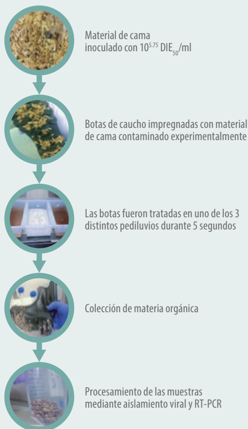
Figura 1. Diseño experimental para determinar la efectividad de pediluvios contra influenza aviar de alta y baja patogenicidad
